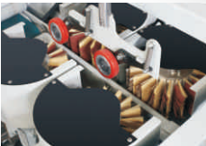
可调节两边的砂光宽度 Both sides sanding width adjustable
