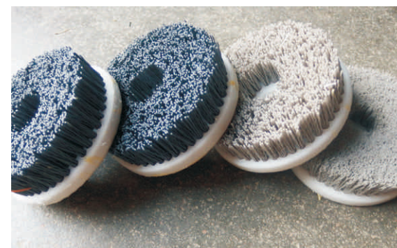
杜邦丝圆盘刷 / DuPont abrasive wire disk
