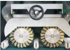
砂光厚度可调，砂辊可移出来，使耗材能最大化利用 Sanding thickness adjustable, sanding rollers removable
