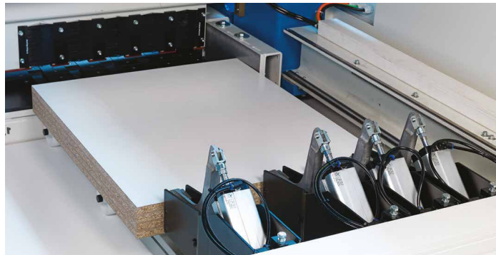
Spintore pannelli con pinze pneumatiche Panels pusher with pneumatic clamps Empujador de tableros con pinzas neumáticas Plattenschieber mit pneumatischen Spannzangen Pousseur panneaux avec pinces pneumatiques
