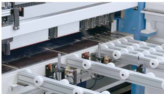
Accostatore automatico posteriore su guida con pattini a ricircolo di sfere Automatic rear aligner with recirculating ball bearing glide Alineador trasero automático con patín de recirculación de bolas Automatischer hinterer Ausrichter auf Führungen mit Kugelzirkulations-Gleitblöcken Aligneur arrière automatique avec glissement par patins à recirculation de billes
