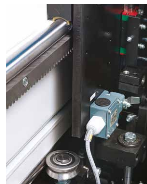
Salita lame indipendenti su guide con pattini a ricircolo di sfere. Avanzamento del carro lame con sistema pignone e cremagliera e scorrimento del carro su guide cilindriche. Independent rising of blades with recirculating ball bearing glide. Saw carriage movement with rack and pinion system and carriage sliding on cylindrical guides. Subida independiente de las hojas con deslizamiento por recirculación de bolas. Avance del carro de las sierras con sistema de cremallera y piñón y deslizamiento del carro sobre guías cilíndricas. Unabhängiger Sägeblattantrieb auf Führungen mit Kugelzirkulations-Gleitblöcken. Sägewagen vorschub mit Ritzel und Zahnstangensystem und Gleiten des Sägewagens auf zylindrischen Führungen. Montée indépendante des lames avec patin à recirculation de billes. Avancement du chariot de la scie avec système à crémaillère et pignon et chariot coulissant sur des guides cylindriques.
