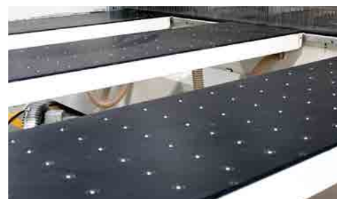
可移动式气浮珠平台 Available air floating bead platform
