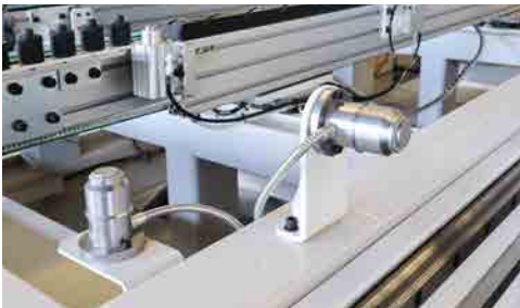
高精度自动对刀装置 High precision automatic tool setting device
