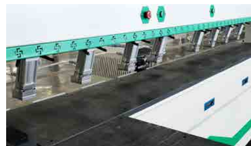
多工位可移动式压料结构 Multi-station movable press structure
